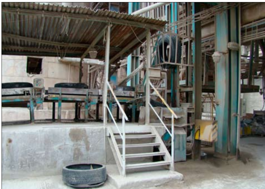
Obrázok 5. - Časť dávkovacieho zariadenia na podávanie opotrebovaných pneumatík a gumového odpadu v Považskej cementárni a.s. Ladce
