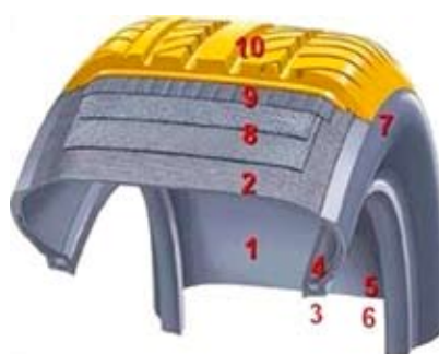
Obrázok 3. - Konštrukcia pláštá (1 – vnútorná guma, 2 – kostrový materiál, 3 – pätkové lanko, 4 – jadro pneumatiky, 5 – vystužujúci pásik, 6 – pätkový pásik, 7 – bočnica, 8 – nárazník, 9 – nárazník, 10 – behúň)
